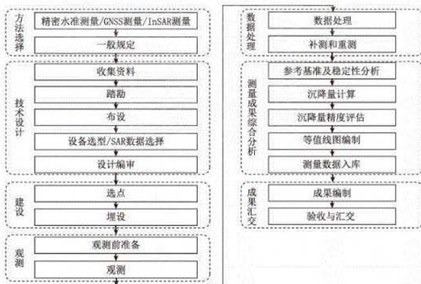
图1 地面沉降测量工作流程示意图
